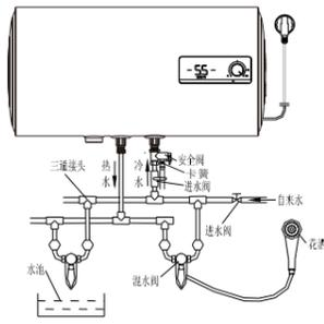
注：以上安装实例中，除安全阀、泄压软管和卡簧为随机配送外，其它部件由用户根据需要自行购买，卡簧用于固定泄压软管。
