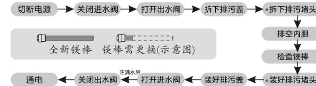
\*拆装排污堵头需使用规格为19mm的套筒。
